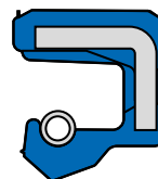
Design BA.. conforming to DIN / ISO Design A Smooth OD
